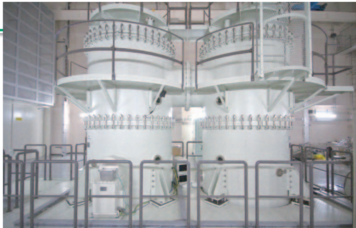
反応科学超高压走査透過電子顕微鏡 JEM 1000K RS 高压タンク
